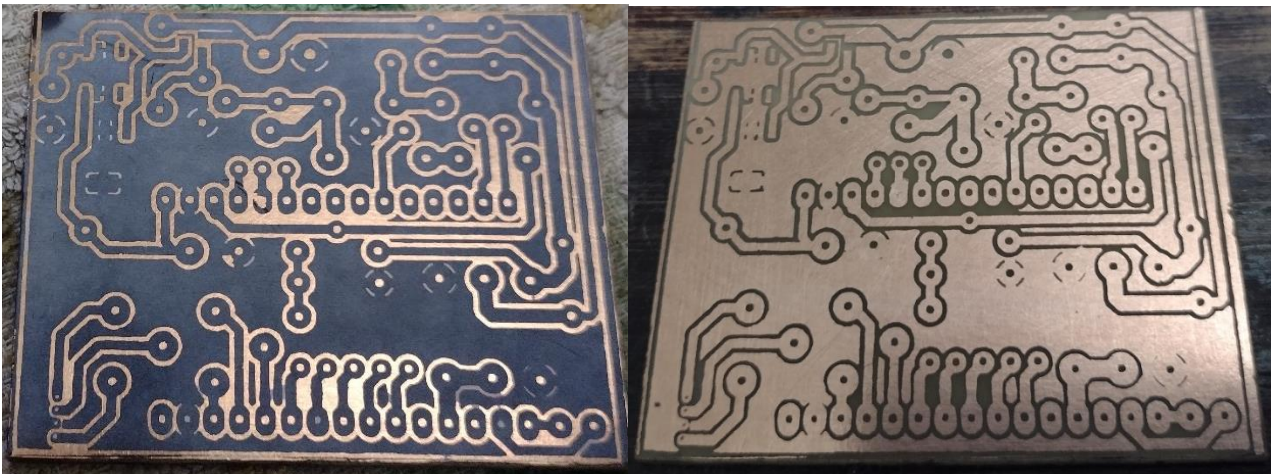
Fig. 5-b: Diseño PCB transferido a la placa de cobre
