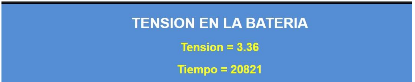
Fig. 11-b: Ensayo duración batería alimentando al Node MCU ESP32.
